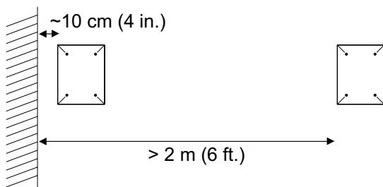
Cuando coloque las cajas alejadas de la pared necesitará de un refuerzo de 3 dB de ecualización en las frecuencias graves.
