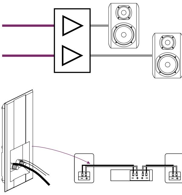
El amplificador para el MONITOR 6 ha de tener una potencia RMS de salida entre 100 W y 200 W a 8 ohmios. El amplificador para el MONITOR 8 ha de tener una potencia RMS de salida entre 125 W y 250 W a 8 ohmios. Utilice el amplificador más grande que se pueda permitir dentro del rango recomendado.
