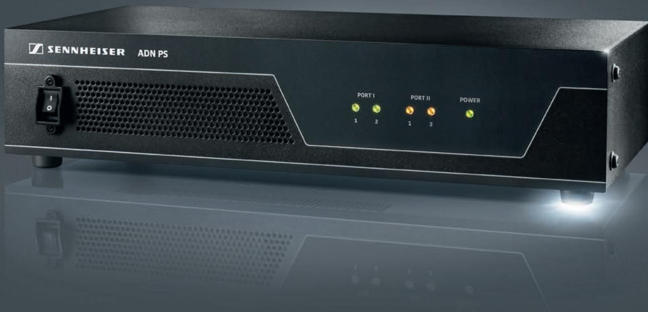
Каскадируемый источник питания ADN PS позволяет расширять систему до 400 участников. Он также увеличивает безотказность системы, обеспечивая резервное кольцевое соединение через два двойных коммутационных порта. Кольцами могут быть соединены до 40 конференц-пультов, соединением обычного типа — до 70 конференц-пультов.
