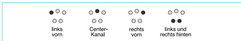
„**TEST**“ sendet ein Testsignal (Rauschen) an jeden der 4 Kanäle: vorn links, vorn rechts, Centerkanal, hinten links und rechts.
