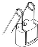
Con il supporto magnetico MZM 10 e MZM 2 il microfono aderisce in modo invisibile ai vestiti. Spesso la forza d'attrito della stoffa è sufficiente per evitare spostamenti dello stesso. In caso di tessuti lisci si utilizza come supporto aggiuntivo la corda da indossare come una collana.
