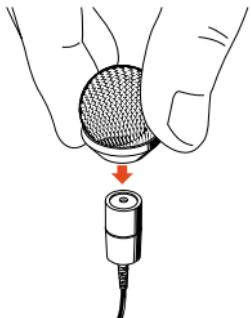
Gebruik in eerste instantie de windbeschermkap MZW 2. Ademhalings- en windgeruis wordt maximaal ca. 20 dB verminderd.
