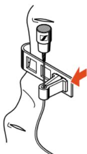
Wenn es der Kleiderstoff erlaubt, können Sie das Mikrofon mit der Anstecknadel MZS 2 befestigen. Diese Befestigung ist mechanisch stark belastbar. Sie bietet sich außerdem an, wenn an der Kleidung keine Aufschläge oder Kanten sind, an denen die Klammer MZQ 2 Halt findet.
