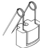
Met de tweedelige magneethouder MZM 10 en MZM 2 kan de microfoon onzichtbaar aan de kleding worden bevestigd. Meestal zorgt het materiaal van de kleding ervoor dat de microfoon niet wordt verschoven. Bij heel gladde stoffen zorgt het bijgeleverde koord voor een stevigere bevestiging aan de achterzijde.
