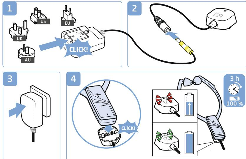
**i** Наушниками можно пользоваться во время зарядки. Однако учитывайте, что приемник во время зарядки может немного нагреваться. На передатчике отображается достигнутый уровень заряда аккумулятора (см. стр. 17).
