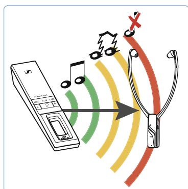
Радиус действия передатчика зависит от условий окружающей среды, например толщины и материала стен. Если вы с наушниками будете выходить за пределы радиуса действия передатчика, сначала звук будет прерываться на некоторое время, а потом вообще пропадет. Вы услышите предупреждающие сигналы в наушниках, индикатор *Статус наушников* будет мигать зеленым (или красным, если аккумулятор почти разряжен).
