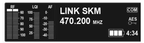
• Главные экраны на обоих дисплеях отображают информацию о состоянии каналов: качество приема, время работы аккумуляторов, уровень аудио и проч. См. «Главный экран».
