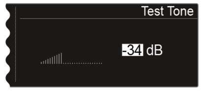
**1** При воспроизведении тестового сигнала аудио сигнал передатчика заглушается.
