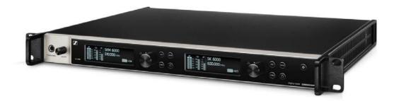
Цифровой 2-канальный приёмник работает на переключаемых полосах 244 МГц в диапазоне от 470 до 714 МГц, который покрывается тремя версиями передатчика. Для создания крупных 4-канальных систем надо соединить шлейфом ЕМ 6000 без доп. антенных сплиттеров, нужна только одна пара антенн.
