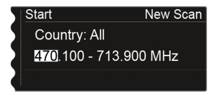
Вы можете отрегулировать значение поворотом безупорного регулятора. Нажатие на регулятор перемещает курсор назад и вперед между отдельными точками частот.
